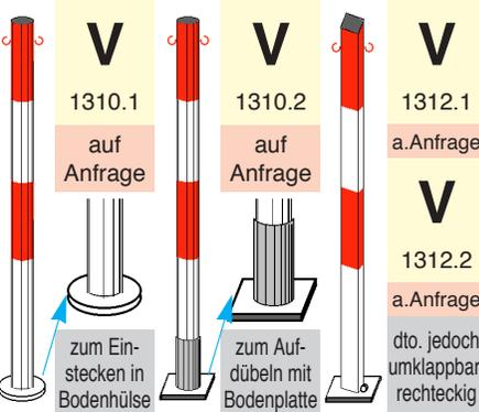
Posten bestehend aus wetterfestem, feuerverzinktem Stahl, rot-weiß lackiert mit Bodenhülse (1310.1) oder -platte (1310.2) ø 60 mm rund (70x70 klappbar) 1,00 m hoch.
